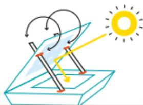
**3/** Solare Speisezubereitung mit dem Sunlab. Benutze das Visier, um den Ofen zur Sonne auszurichten. Richte den Schatten des Stabes auf die rote Spange des. Visiers aus. Erneute Ausrichtung alle 15 Minuten.
