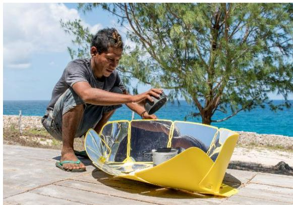
Sungood se déploie en 5 minutes. Il suffit de le déplier (deux positions possibles), poser le récipient au centre du repose-plat et l'orienter face au soleil. Les rayons du soleil vont se réfléchir sur les miroirs du cuiseur et se concentrer sur le plat.
